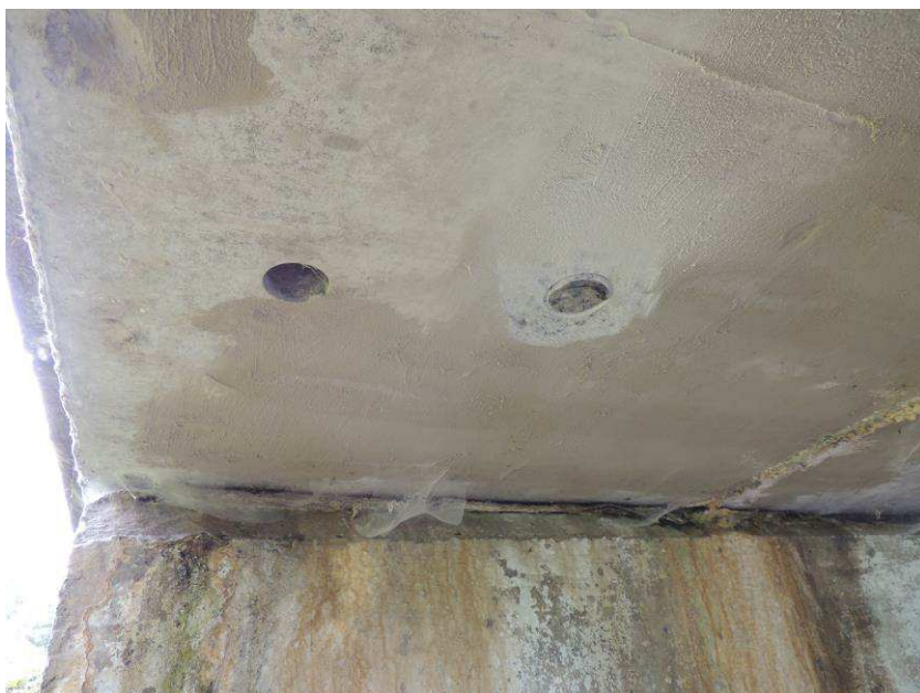
Zkušební místo pro stanovení soudržnosti betonu odtrhovým přístrojem a pevnosti betonu Schmidtovým tvrdoměrem nosníku N11
