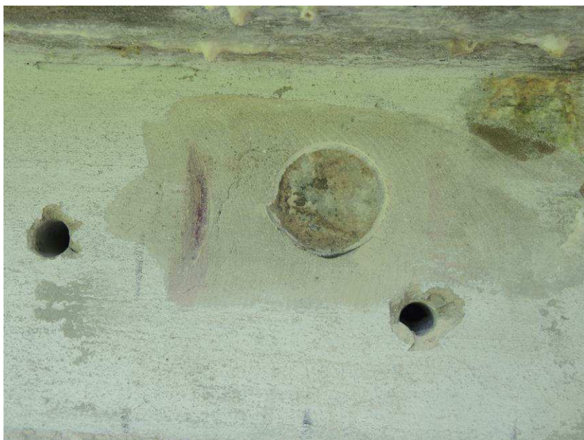
Zkušební místo pro stanovení soudržnosti betonu odtrhovým přístrojem a pevnosti betonu Schmidovým tvrdoměrem nosníku N1
